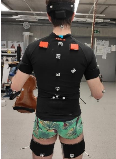
Abb. 2: Beispielhafte Anbringung der Sensoren und Marker
